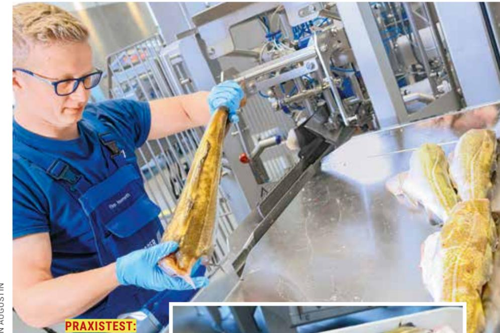
**PRAXISTEST:** Mitarbeiter Finn Nemeth beschickt die Filetiermaschine mit einem Kabeljau.
