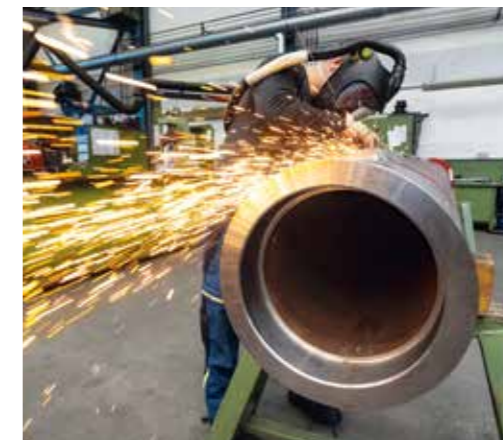
IN DER PRODUKTION: Ein Monteur bearbeitet die Brecherwelle eines Walzenbrechers.
