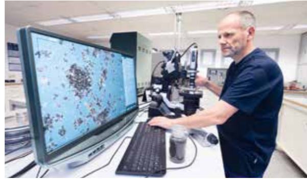
ANALYSE: Für die Datenbank werden die verschiedenen Schüttgüter auch mikroskopisch untersucht.
