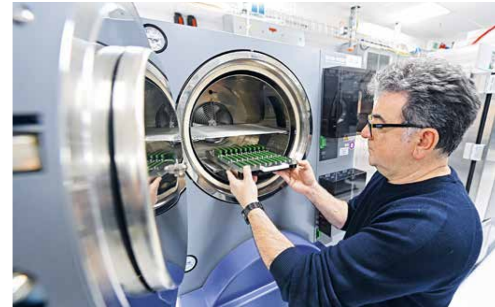
TEST-VORBEREITUNG: Davar Amroudi beschickt ein Gerät, in dem die Halbleiter hohen Temperatur- und Druckunterschieden ausgesetzt werden, um zu testen, ob sie durchhalten.
