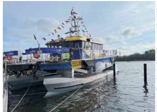
GUT GEGEN SEEGANG: Das 18 Meter lange Schiff steht auf zwei Katamaran-Rümpfen, die beweglich gelagert sind.
