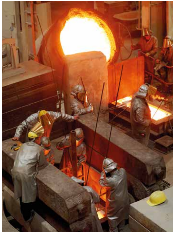
GUSS: Auf 1.172 Grad Celsius erhitzte Schmelze fließt in eine Form.
