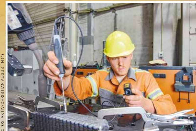
NEULAND: Jan-Ole Thurow an einen Rohling, der in einem neuen 3-D-Schichtverfahren auf einer Roboter-Metallschweißanlage entstand.
